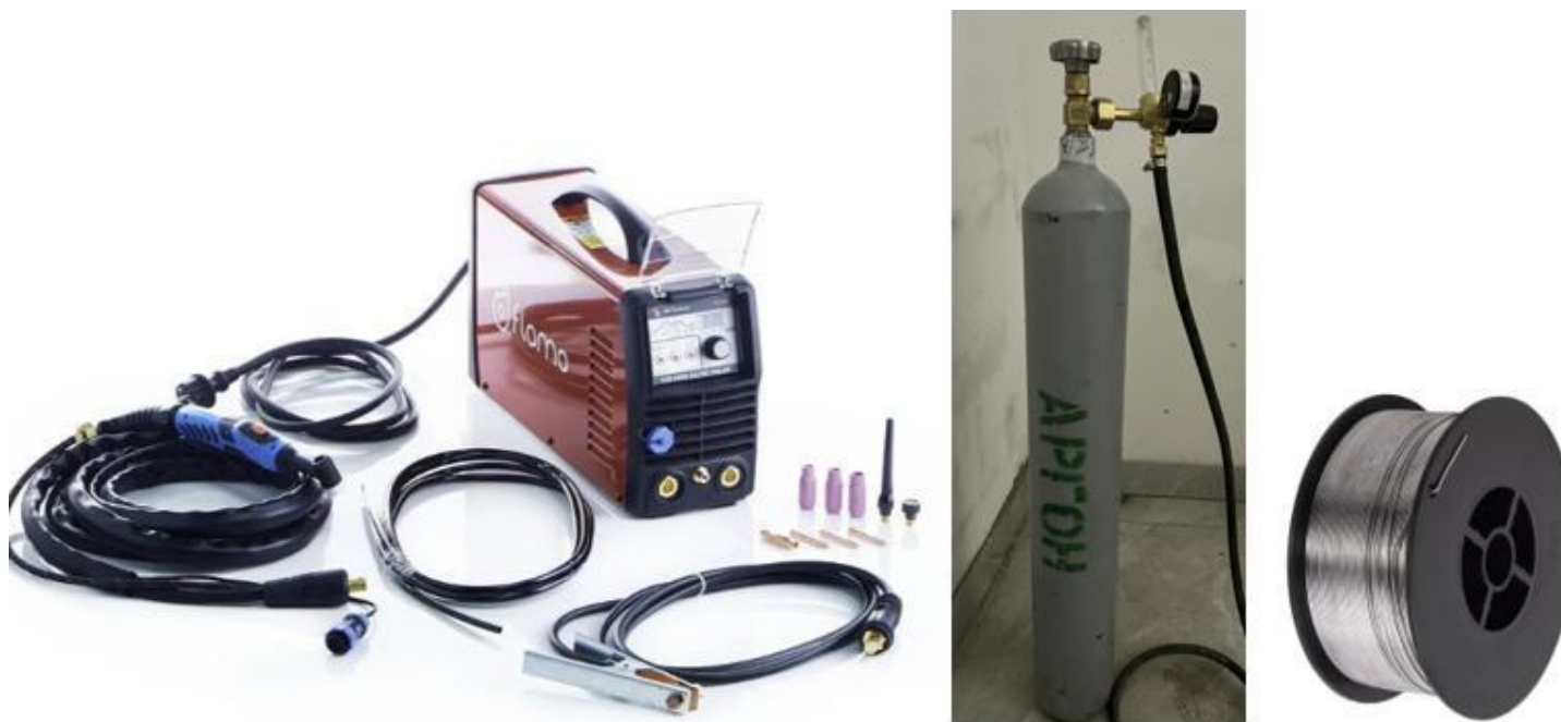
1.3-сурет – Аргон доғалық дәнекерлеуге арналған инвертор және инертті газ (аргон)
